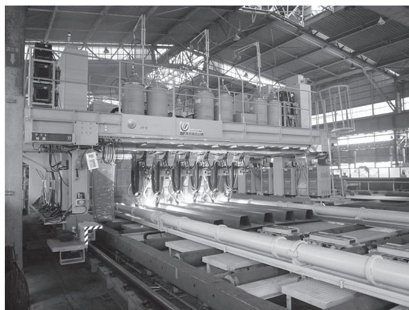
写真5 フランジパネル溶接ロボット (更新機)
