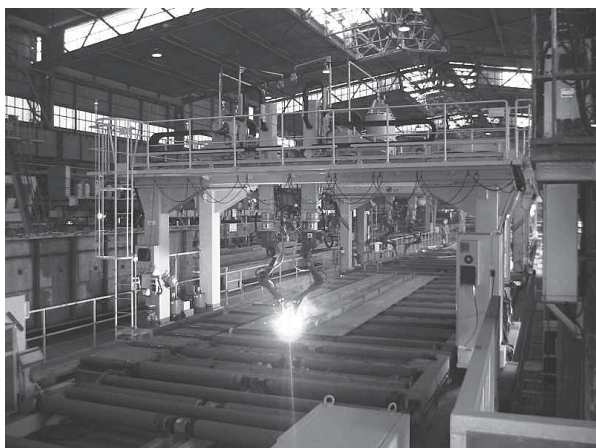
写真3 ウェブパネル溶接ロボット (更新機)
